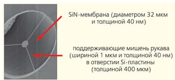
Рис.6. Пример ограниченной nano-микроразмерной мишени для экспериментов по лазерному ускорению ионов (Резерфордская лаборатория, Великобритания).
